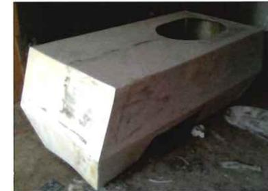
Carrosserie fabriquée avec un moule extérieur en tôles. Gel-coat appliqué directement sur le moule avant la résine et la fibre
